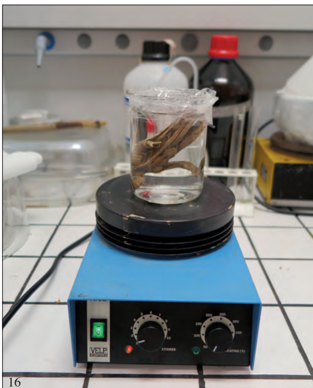
Figg. 16-17 - Il bronzetto durante il lavaggio intensivo su agitatore elettromagnetico per l'estrazione dei sali solubili. Il raggiungimento di valori di conducibilità attorno ai 15 \mu S, associato al cloro-test negativo, determina la sospensione del trattamento (Foto S. Emanuele, Archivio del Laboratorio di restauro SABAP-VE-MET, Padova).
