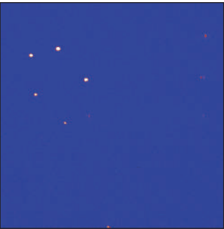
Fig. 2 - Immagine di alcuni picchi di diffrazione dell'aegirina ottenuti per esposizione del cristallo alla radiazione X del molibdeno e registrati dal rivelatore d'area.
