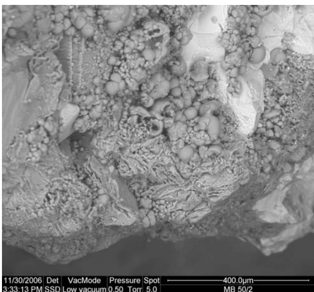
Giorgiosite, aggregati globulari e informi. Cava del "Nido d'Aquila", Punta delle Lucche, Pasubio. Foto SEM.
