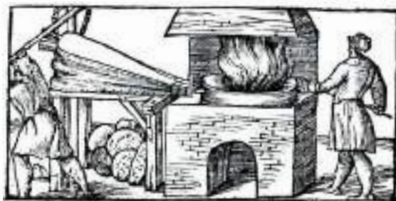
Fig. 3 – Fucina per la lavorazione del rame (da libro III di Biringuccio, De la pirotechnia )
